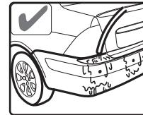
Пожалуйста, мойте датчики под низким давлением воды, после мойки продуйте датчики сжатым воздухом для удаления влаги
