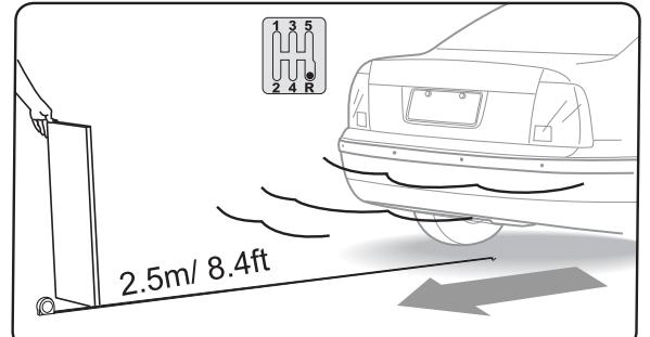
Данный тест возможен с применением плоской деревянной доски размером 30x100см: держите доску позади автомобиля и управляйте автомобилем для проверки каждого датчика системы, как показано на рисунке.
