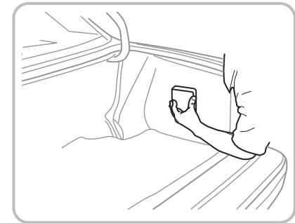
Выберите безопасную/сухую область, чтобы установить модуль ЭКЮ. Используйте самоклеящийся участок на блоке с застежкой на липучке, чтобы установить ЕКЮ в транспортном средстве. Убедитесь что датчик реагирует, достигнет до установленного местоположения.
