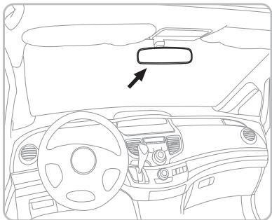
Автозатемняющийся монитор должен быть установлен на штатное зеркало заднего вида в автомобиле.
