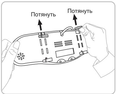
Выдвиньте упругую скрепку позади автозатемняющегося монитора зеркала.
