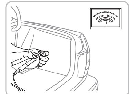
Соедините красный провод с проводом сигнала остановки в автомобиле.
