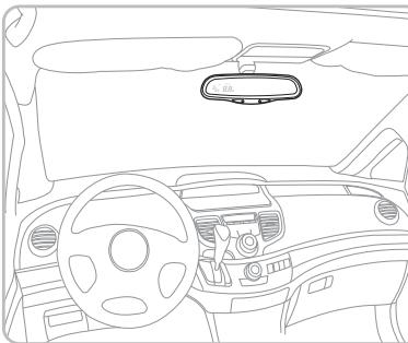
Поместите автозатемняющийся монитор зеркала на оригинальное зеркало заднего вида и отрегулируйте обзор, чтобы водитель мог без проблем наблюдать ситуацию позади автомобиля.
