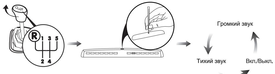
Включите зажигание и нажмите кнопку регулирования громкости звука, чтобы выбрать наиболее подходящий уровень звука или же выключить звук.
