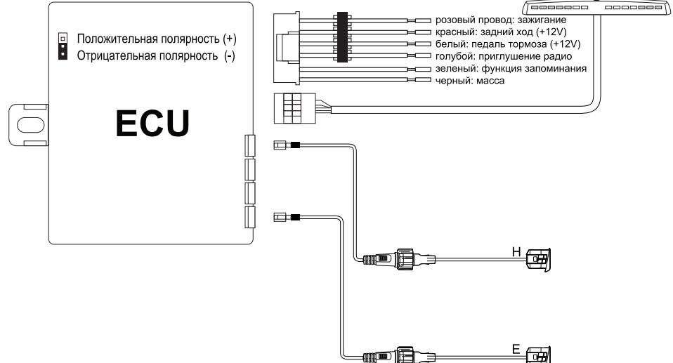
Для автомобилей оборудованных CAN-шиной, используйте дополнительное реле в цепи питания системы парковки.
