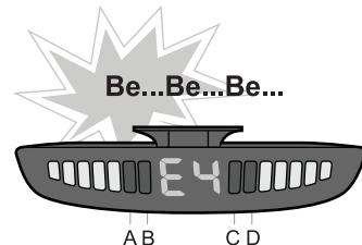
местоположение неисправного датчика
