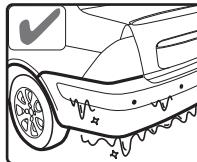
Пожалуйста, очищайте датчики от льда с помощью горячей воды, продуйте датчики сжатым воздухом, для удаления влаги
