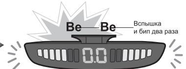
Включите зажигание, переместите ручку коробки передач из позиции N в позицию R 10 раз с интервалом в 1 сек. На 10-ый раз останьтесь в позиции R на 6 сек. Это активизирует функцию запоминания и система больше не будет реагировать на выносной элемент автомобиля. Включите зажигание, переместите ручку коробки передач из позиции N в позицию R 12 раз с интервалом в 1 сек. На 12-ый раз останьтесь в позиции R на 8 сек. Это обнулит функцию запоминания.
