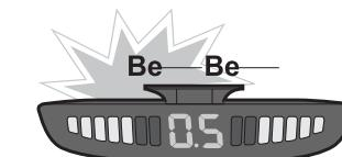
При программировании функции запоминания все ультразвуковые датчики должны быть подключены к системе. Если при программировании какой-либо датчик был отключен, то при его дальнейшем подключении индикатор будет показывать постоянное наличие препятствия по соответствующему каналу. Данная ошибка устраняется повторным перепрограммированием системы со всеми датчиками.
