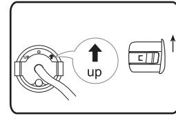
5. Датчик устанавливается вертикально, надпись «up» должна быть строго вертикально
