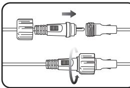
7. Вставьте штекель в гнездо и сильно поверните герметизирующую гайку винта
