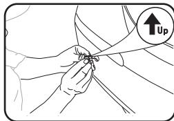
6. Вставьте датчики в отверстия и плотно закрепите в бампере
