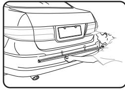
3. Поделите расстояние между датчиком А и Д на три части. Отметьте эту площадь под датчики В и С.
