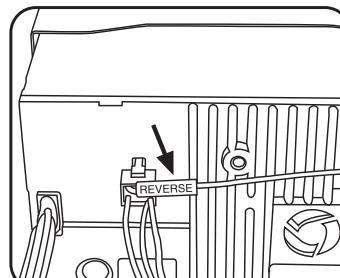
2. Соедините провод лампы заднего хода с проводом стоп сигнала и вставьте в разъем для проводов, который находится на обратной стороне встроенного A/V монитора.
