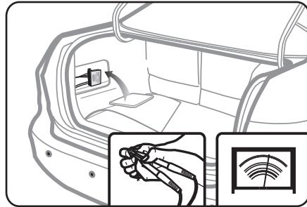
Соедините красный провод с проводами стоп сигнала автомобиля
