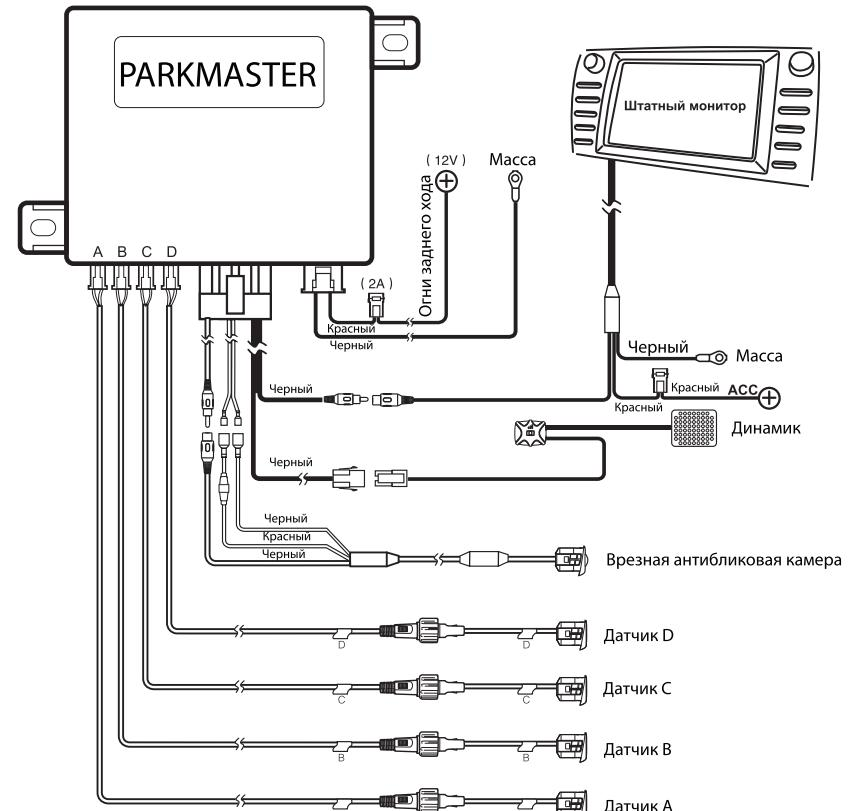
Для автомобилей оборудованных CAN-шиной, используйте дополнительное реле в цепи питания системы парковки.
