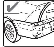
Пожалуйста, мойте датчики под низким давлением воды, после мойки, продуйте датчики сжатым воздухом, для удаления влаги
