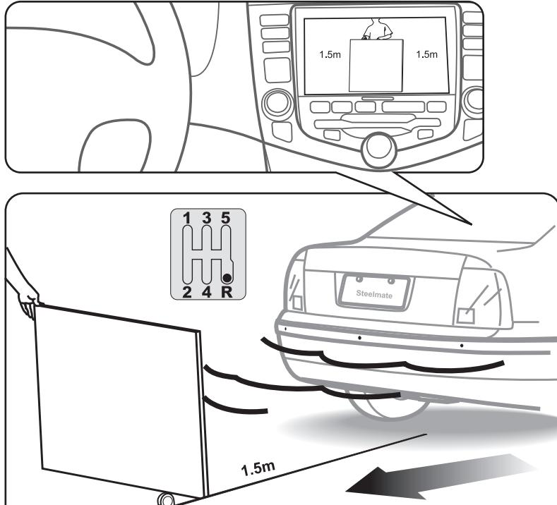
Данный тест возможен с применением плоской деревянной доски размерами 30x100см: держите ее позади автомобиля и управляйте автомобилем для проверки каждого датчика системы, как показано на рисунке.
