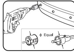
4. Сравните диаметр фрезы с диаметром датчика, прежде чем делать какие-либо отверстия
