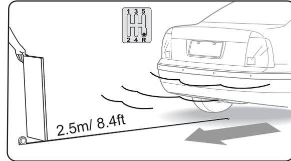
Данный тест возможен с применением плоской деревянной доски размером 30x100см: держите доску позади автомобиля и управляйте автомобилем для проверки каждого датчика системы, как показано на рисунке.
