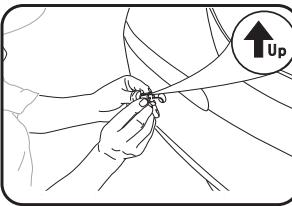
6. вставьте датчик в отверстие и вдавите внутрь
