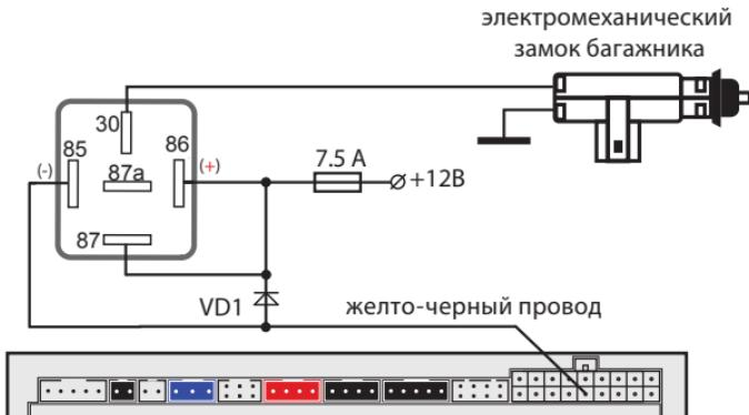
В этой схеме для открывания багажника используется доп. канал №1 (желто-черный провод разъема X1). При подключении необходимо использовать дополнительное реле, а программируемую функцию 14 настроить в вариант 1 (см. стр. 42).
