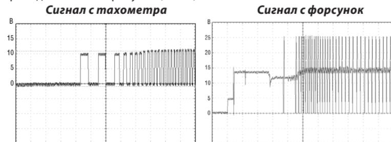
В качестве сигнала, пропорционального скорости вращения двигателя, также может быть взят сигнал от цепи управления форсунками. В большинстве случаев он позволяет надежно определять состояние работающего двигателя.
