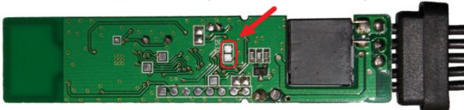
2. на 10 секунд подайте питание на реле. После отключения питания разомкните контактные площадки; теперь реле снова можно записать в автосигнализацию.
