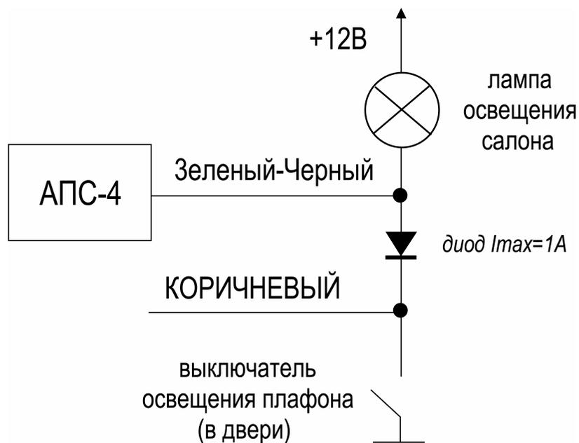
2. Рекомендуемая схема подключения Коричневого провода системы ("отрицательный триггер двери") к проводке автомобилей ВА3 семейств 2110 и 2115, оснащенных иммобилайзерами АПС-4:
