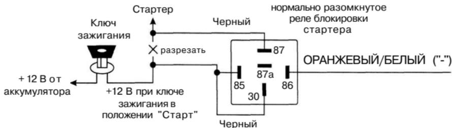
**Примечание:** Обратите внимание на то, что при использовании такого варианта подсоединения реле блокировки стартера питание на реле блокировки будет подаваться только в момент попытки завести двигатель, таким образом, реле блокировки будет потреблять энергию аккумулятора только в момент попытки запуска двигателя (или только при включении зажигания).
