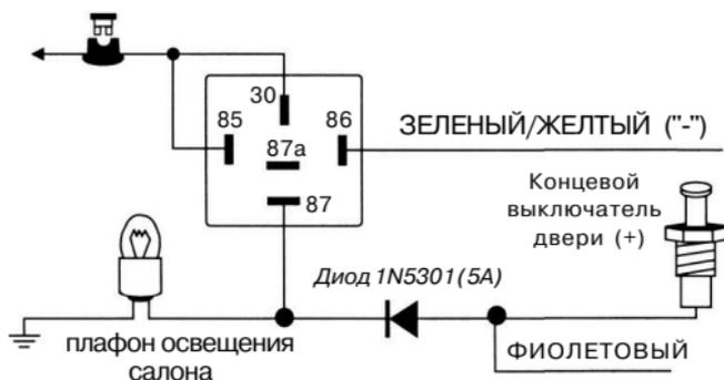
**Подсоединение:** Подсоедините ЗЕЛЕНЬИЙ/ЖЕЛТЫЙ провод к клемме № 86 дополнительного ЗОА реле и подсоедините клемму № 85 реле к +12В через предохранитель. Подсоедините остальные контакты реле в соответствии с полярностью цепи внутрисалонного освещения автомобиля как показано на схеме.
