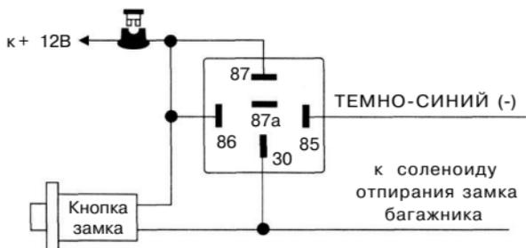
2) Выход канала 2 системы (ТЕМНО-СИНИЙ провод) может также использоваться для управления различными иными дополнительными устройствами. Режим работы выхода канала 2 в этом случае может быть запрограммирован при установке системы (программируемая функция № 19) как:
