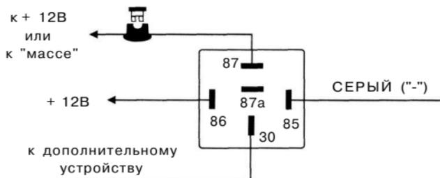
**Подсоединение:** Подсоедините СЕРЫЙ провод к клемме № 85 дополнительного 30А реле, подсоедините клемму № 86 реле к +12В. Подсоедините остальные контакты реле в соответствии с выбранной функцией канала 3 системы.
