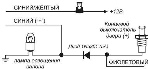
**ВНИМАНИЕ: Обязательно** используйте диод для изолирования цепи управления внутрисалонным освещением от цепи триггера двери. В противном случае не сможет правильно работать функция пассивной постановки на охрану и функция автоматической повторной постановки системы в режим охраны.
