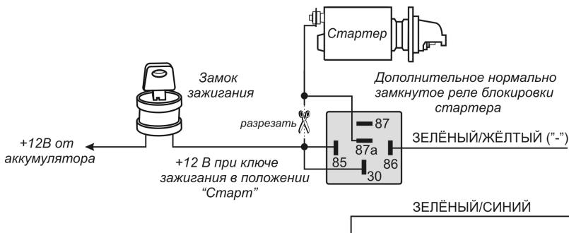
Схема подключения ЗЕЛЁНОГО/ЖЁЛТОГО провода для блокировки цепи зажигания автомобиля:
