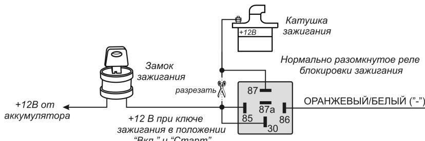
**Примечание:** Обратите внимание на то, что питание на реле блокировки будет подаваться только в момент попытки завести двигатель. Таким образом, реле блокировки будет потреблять энергию аккумулятора только в момент попытки запуска в то время, когда система находится в режиме охраны.
