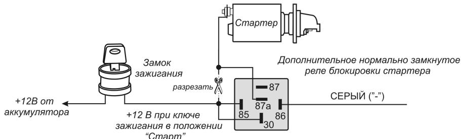
Схема подключения СЕРОГО провода для блокировки цепи зажигания автомобиля:
