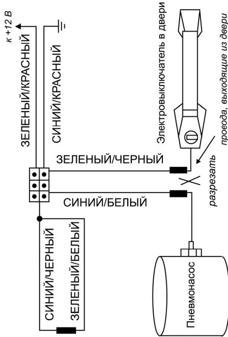
**Схема 5. Однопроводный тип цепи дверных замков с отрицательной полярностью (некоторые автомобили марки Nissan, Mazda и др.)**
