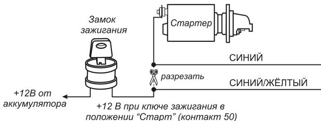
Схема подключения СИНЕГО провода для блокировки цепи зажигания автомобиля:
