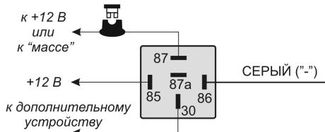
2) Вы также можете использовать СЕРЫЙ провод для того, чтобы система подавала питание на замок зажигания в течение определенного времени. **В этом случае Вы сможете ставить систему в режим охраны с заведенным двигателем, не оставляя ключи в замке зажигания** (если программируемая функция № 1.13 включена):
