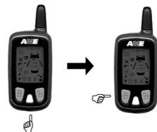
Если пульт управления какое-то время находился вне зоны связи с системой, по возвращении в зону связи, нажав последовательно кнопки 3 и 1, Вы можете проверить, не изменилось ли состояние системы в Ваше отсутствие. Если состояние системы изменилось, индикация на дисплее поменяется. Если состояние не менялось, индикация останется прежней.
