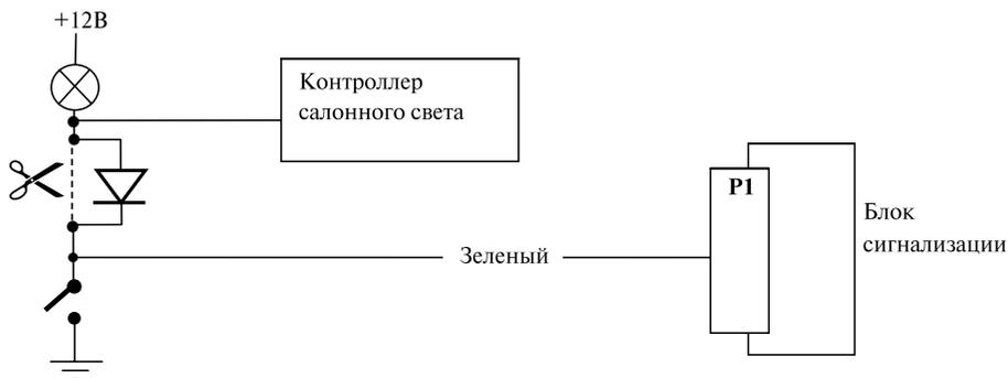
**Подключение встроенного реле стартера с функцией блокировки стартера и защитой от повторного включения стартера**
