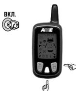
Ваша охранная система оснащена специальной противоразбойной функцией Anti Hi-jack, которую Вы можете включить с пульта управления. Для включения Anti Hi-jack нажмите одновременно при включенном зажигании кнопки 2 и 3.
