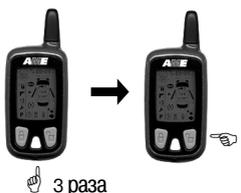
Для отключения или включения **звукового сигнала** трижды нажмите кнопку 3, а затем кнопку 2. Включение сигнала пульт подтвердит короткой мелодией, при отключении сигнала нажатие кнопки 2 не сопровождается звуковым сигналом.
