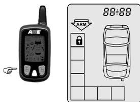
Чтобы поставить сигнализацию на охрану нажмите при выключенном зажигании кнопку 1 пульта управления, если все двери, капот и багажник закрыты, сирена подаст один звуковой сигнал, и фонари мигнут один раз. Светодиод системы начнет медленно мигать, дверные замки закроются (если автомобиль оборудован приводами блокировки замков).
