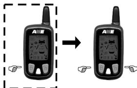
При срабатывании сигнализации, находящейся в режиме тихой охраны, индикация тревоги производится только индикаторными фонарями и по каналу пейджера, сирена не включается. Для включения режима нажмите одновременно кнопки 1 и 2 в любой момент в режиме охраны. Режим тихой охраны автоматически отключается при снятии сигнализации с охраны.
