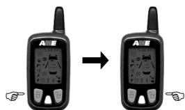
Если при снятии с охраны необходимо отключить звуковые сигналы нажмите кнопку 1 перед нажатием кнопки 2. Выполнение команд в этом случае будет подтверждено только световыми сигналами. В остальном режим полностью аналогичен снятию с охраны со звуковым подтверждением. В случае включения тревоги в период охраны звуковое предупреждение о включении тревоги сохранится.
