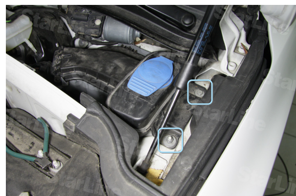
Фото 5.2. Панель снята, крепление горловины бачка стеклоомывателя (болт и гайка)
