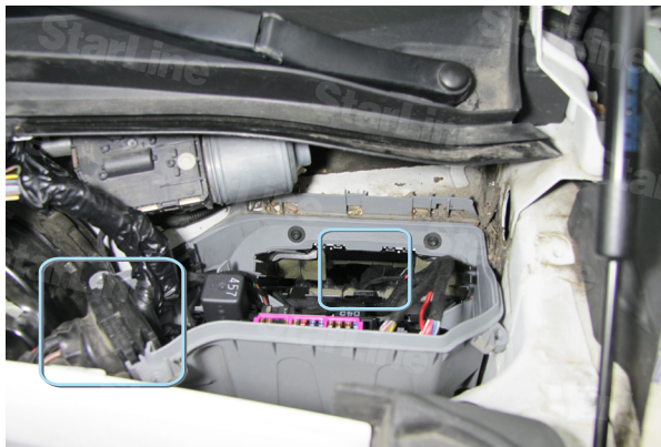
Фото 7.3. Штатный проем и уплотнитель для прокладки проводов под капот
