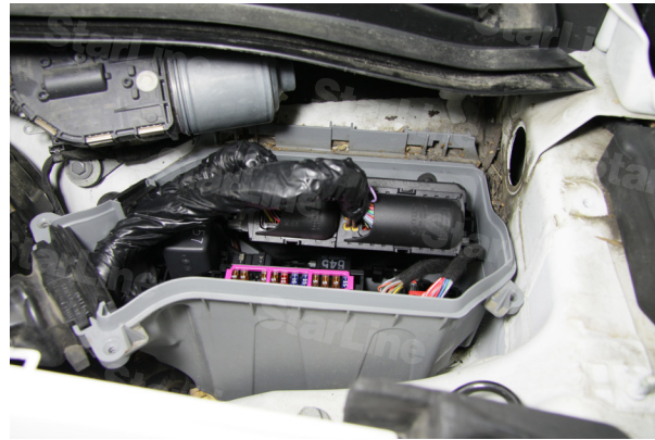
Фото 5.4. Крышка снята, блок управления двигателем
