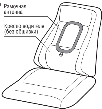
Установка рамочной антенны на кресло водителя
