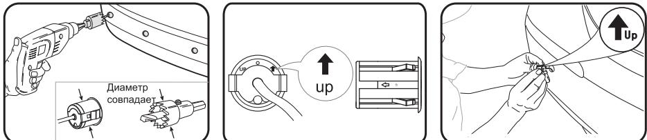
4. проверьте перед работой: диаметр датчика должен совпадать с размером фрезы
