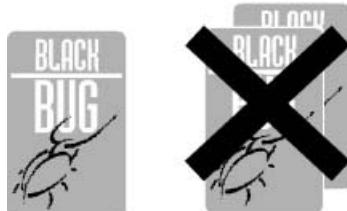
В зоне опознавания может находиться не более одной карточки. Внесение в зону нескольких карточек делает невозможным их опознавание системой.
