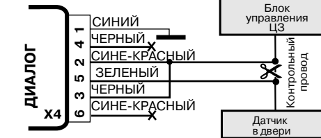
Рис. 11. Схема подключения к центральному замку, которому для отпирания требуется отрицательный импульс, а для запирания - разъединение проводов
