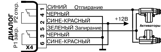
Рис. 6. Схема подключения дверных замков с инверсией полярности
