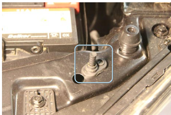
Фото 6.5. Концевик капота (отрезать 0,5 деления)
