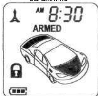
Предупреждение о незакрытом капоте или багажнике
