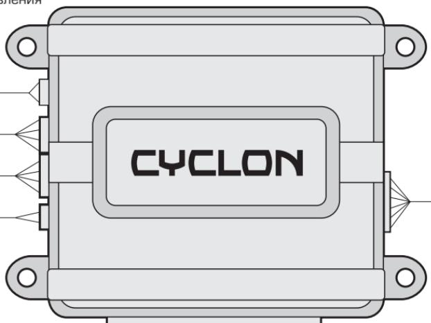
24-х контактный разъем управляющего блока
