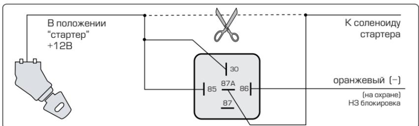
**Оранжево-черный провод:** выход отрицательной полярности на реле блокировки стартера (250mA). Используется реле с нормально разомкнутыми контактами.
