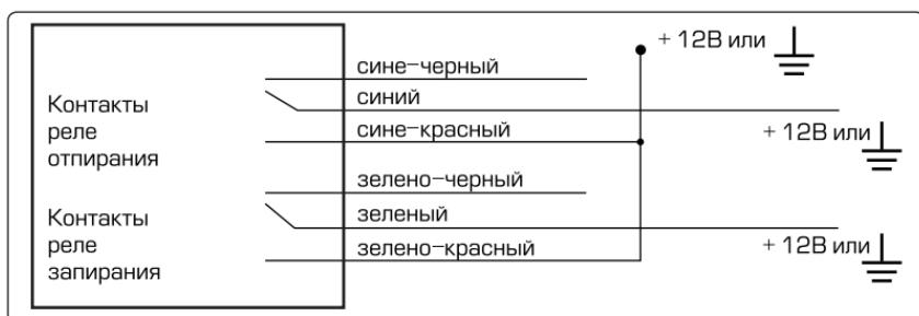
Схема подключения к двухпроводным приводам системы запирания
