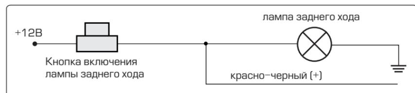
Данный провод необходимо подключить к штатному проводу автомобиля, на который подается питание +12В от концевого выключателя лампы заднего хода. При появлении +12В на красно-чёрном проводе сигнализация начинает подавать предупредительные сигналы в виде звуков сирены и мигания габаритных огней [либо поворотных огней – в зависимости от места подключения двух белых проводов сигнализации].
