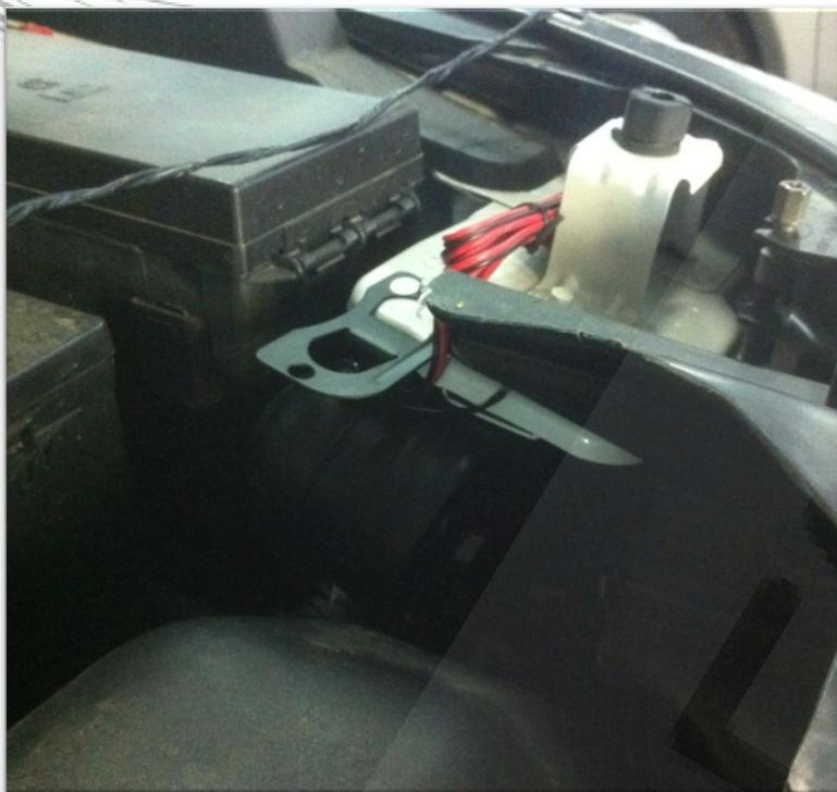
Для подключения сирены необходимо также провести в моторный отсек коричневый провод разъема CN3 системы Scher-Khan Logicar 4 и соединить его с красным проводом сирены. Черный провод сирены соединить с «массой» автомобиля. Сирену располагать рупором вниз или в сторону.
