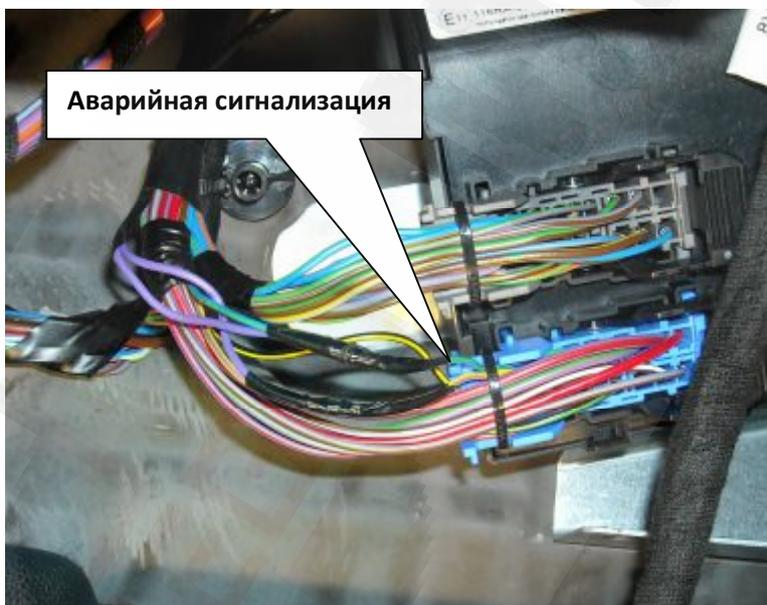
Для управления включением/выключением аварийной сигнализации следует фиолетовые провода разъема CN2 системы Scher-Khan Logicar3 подключить к желтому/фиолетовому и синему зеленому проводам расположенным в большом синем разъеме блока BCM. Красный/белый провод разъема CN2 системы Scher-Khan Logicar3 подключить к
