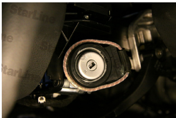
Фото 16. Рамка модуля обхода иммобилайзера
