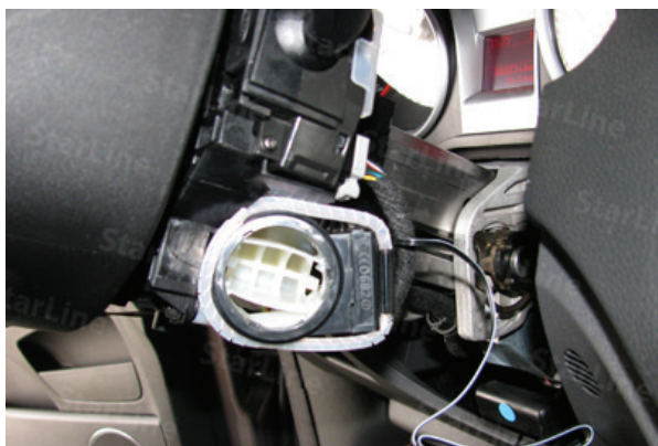
Фото 13.1. Размещение антенны обходчика
