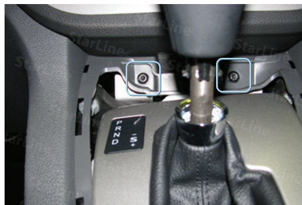
Фото 1.4. Откручиваем два самореза
