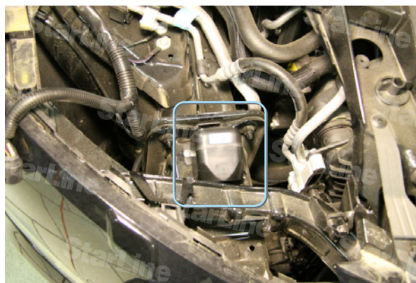
Фото 6.4. Сирена (крепление на 2 самореза)
