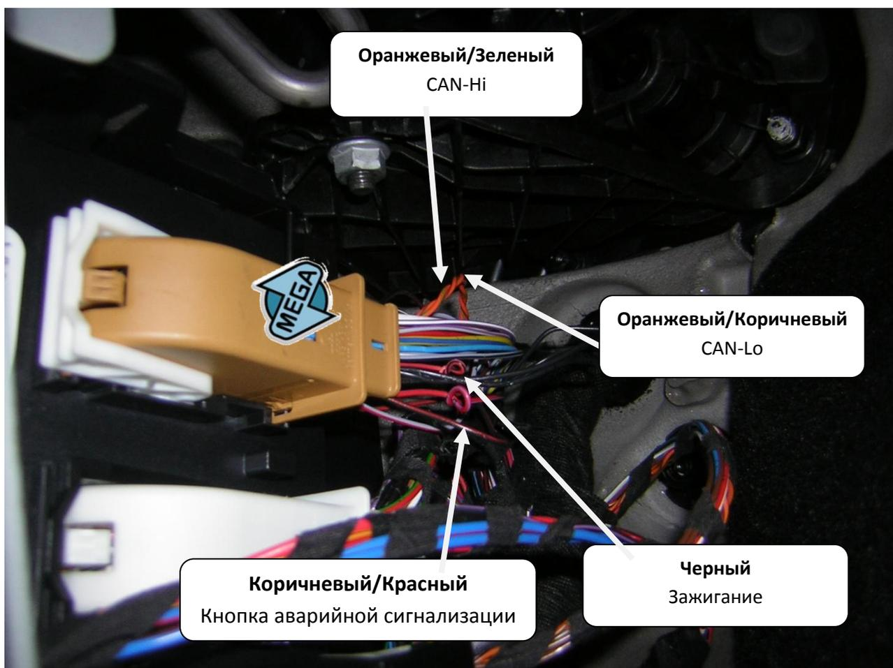
*В VW Golf CAN-шина проложена по всему автомобилю. Место подключения к CAN-шине автомобиля может быть выбрано другое, это не повлияет на работоспособность компонентов автомобиля и сигнализации Scher-Khan Logicar 3.*
