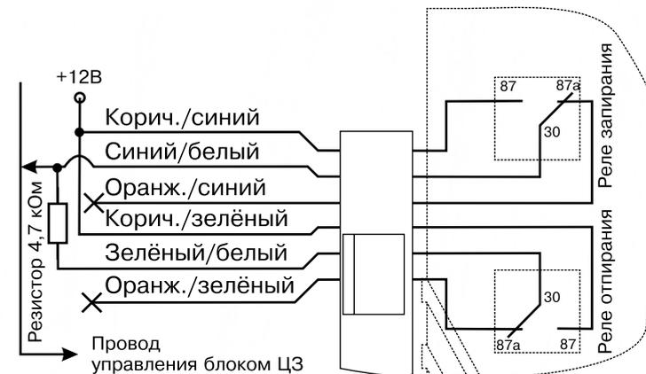
Автомобили с однопроводной схемой управления ЦЗ, в которых для запириания и отпириания требуется отрицательный импульс (масса) на проводе управления
