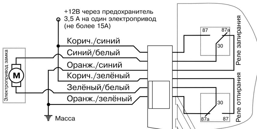
Автомобили, в которых для запертия центрального замка требуется состояние «разомкнуто», а для отпирания — положительный импульс
