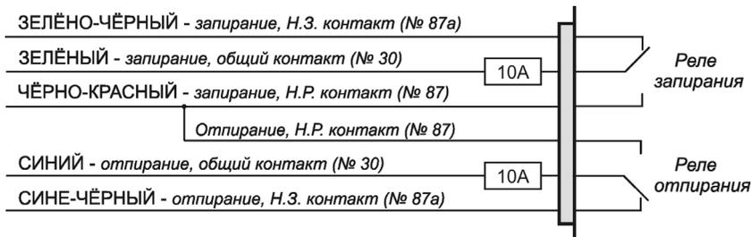
Перед подключением системы к штатным электроприводам замков дверей необходимо определить тип штатной системы центрального замка. Для этого – выньте выключатель дверного замка из панели двери водителя и протестируйте провода, идущие от выключателя.
