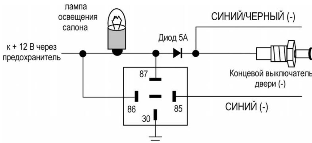
При положительных концевых выключателях дверей:
