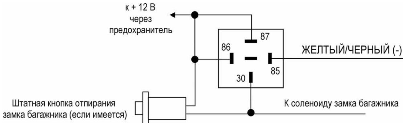
**ЖЕЛТЫЙ/КРАСНЫЙ провод:** отрицательный выход 2-го канала системы для реализации функции отпирания дверей в 2 этапа или для дистанционного управления дополнительными устройствами. Максимальный ток нагрузки 300мА, для подключения требуется дополнительное реле. Длительность импульса выходного сигнала программируется как импульсный 0,7 с, таймерный от 1 до 60 секунд (с отключением датчиков системы или без отключения датчиков) или “постоянный” (“защелка”) см. программирование функции # 1.14.
