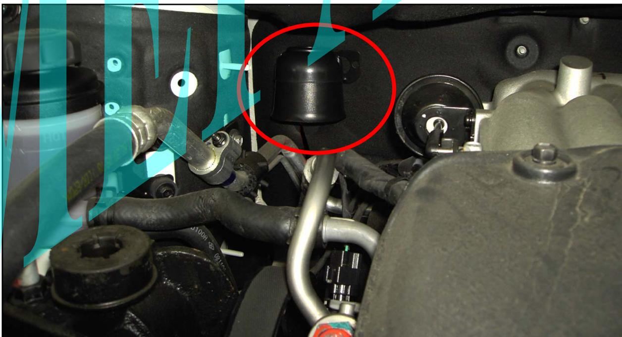
Рис. 4. Возможное место установки сирены.
