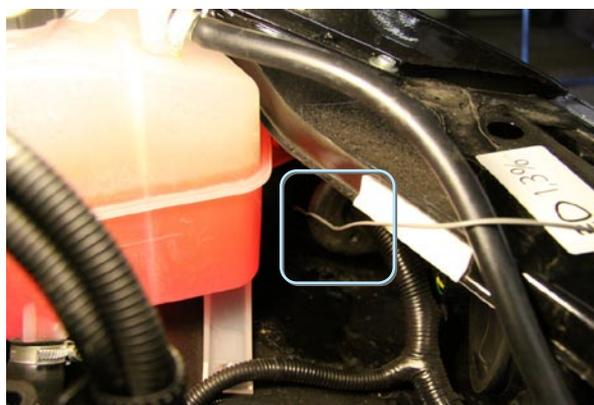
Фото 5.2. Выход проводов под капотом
