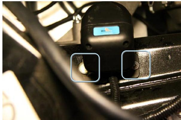
Фото 4.2. Сирена. Крепление на болт М8 и саморез
