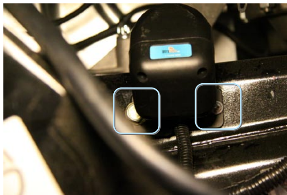
Фото 4.2. Сирена. Крепление на болт М8 и саморез
