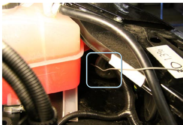
Фото 5.2. Выход проводов под капотом
