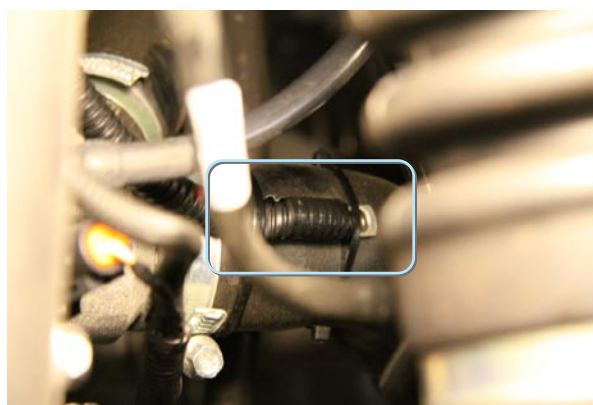
Фото 4.6. Датчик температуры. Крепление хомутами
