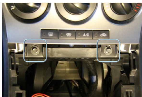
Фото 1.6. Саморезы крепления тоннеля
