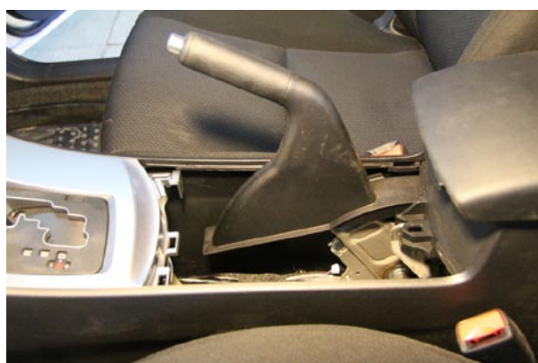
Фото 1.3. Демонтаж накладки стояночного тормоза
