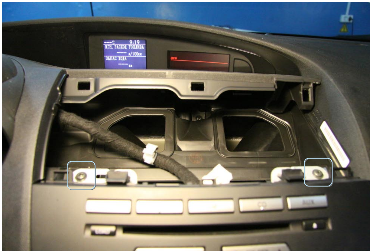
Фото 5.1. Снятие воздуховодов и крепление магнитолы
