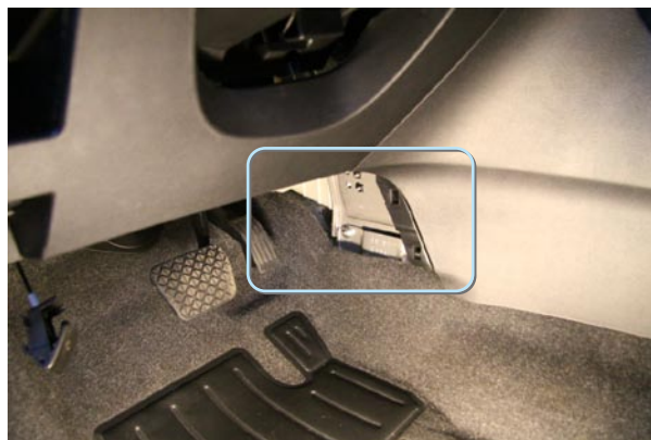
Фото 1.1. Накладка тоннеля с левой стороны
