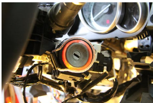
Фото 17. Рамка модуля обхода штатного иммобилайзера
