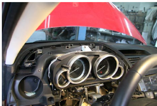
Фото 3.1 Снятие облицовки. Общий вид
