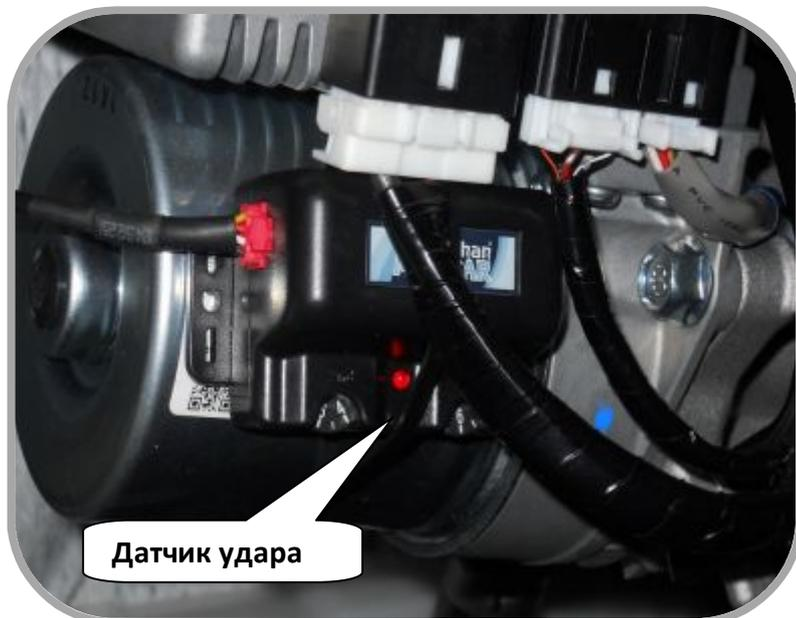
По окончании установки системы обязательно произвести его регулировку с помощью поворотных регуляторов на корпусе!
