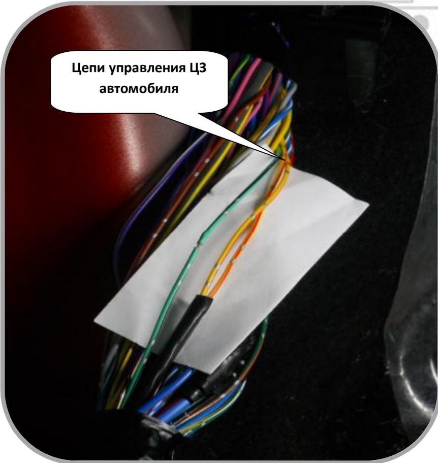
\* В месте подключения желтый/красный провод имеет заводскую скрутку и расходится на 2 линии, для подключения можно использовать любую из них.
