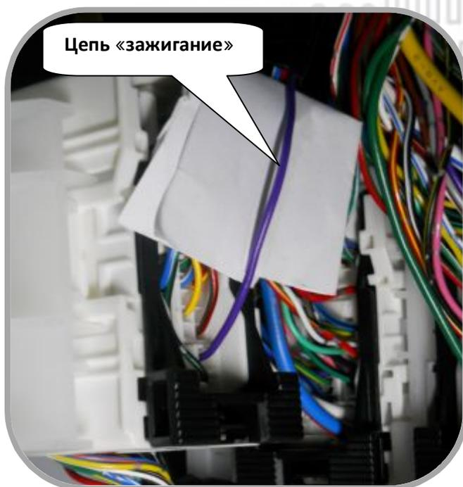
**Зеленый провод** («+ зажигание») разъема CN3 системы Scher-Khan Magicar 10 подключить к **фиолетовому** проводу, расположенному в боковом белом разъеме в ногах водителя.
