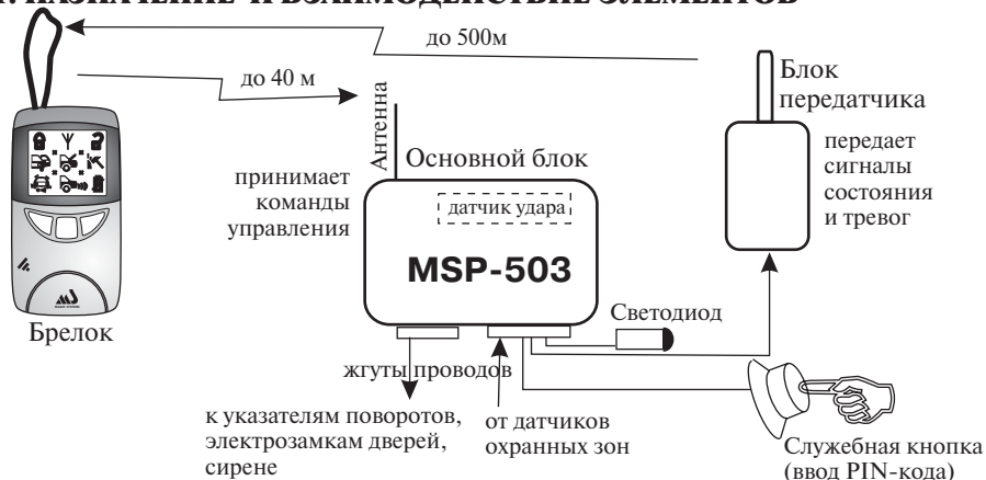
Рис.1. Взаимодействие элементов автосигнализации
