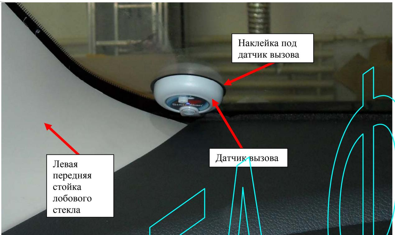
Рис. 10: Возможное место установки датчика вызова владельца.
