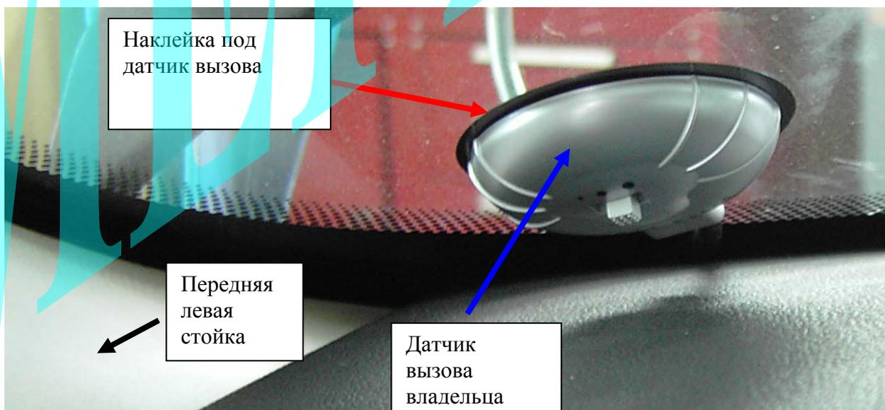
Рис. 12: Возможное место установки датчика вызова владельца.
