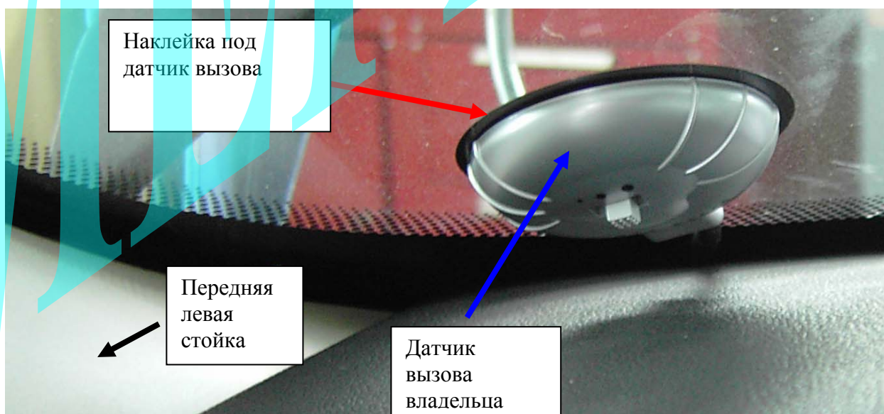
Рис. 10: Возможное место установки датчика вызова владельца.
