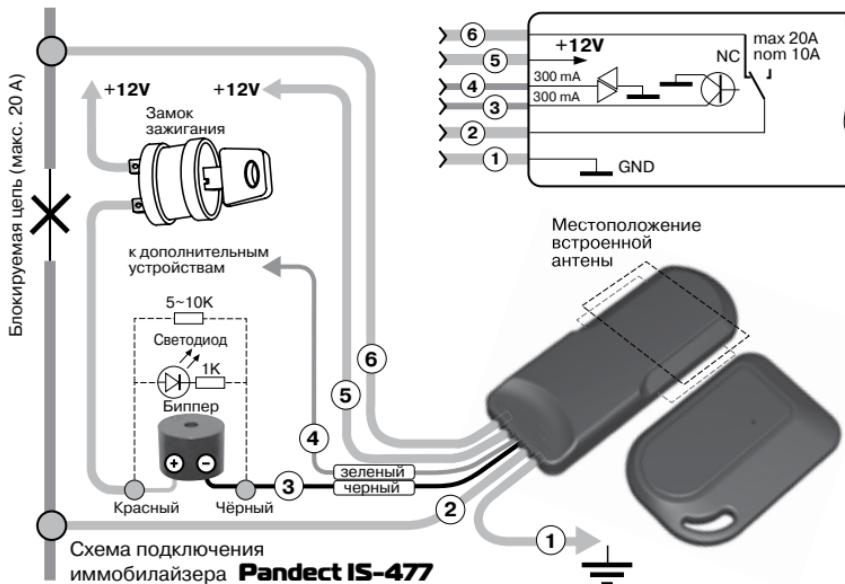
Требования к монтажу радиореле аналогичны монтажу модуля блокировки. Размещение дополнительного радиореле для устойчивой связи с модулем блокировки рекомендуется делать не дальше 2,5-3 метров друг от друга, учитывая условия экранирования сплошными металлическими поверхностями. Система позволяет использовать до трех дополнительных радиореле управляемых динамическим кодом с модулем блокировки.
