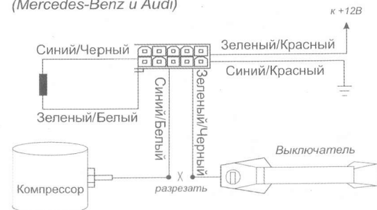
Схема 4. Вакуумная система центрального замка (Mercedes-Benz и Audi)
