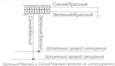
Схема 1. 3-проводная система с отрицательной полярностью (большинство японских автомобилей)
