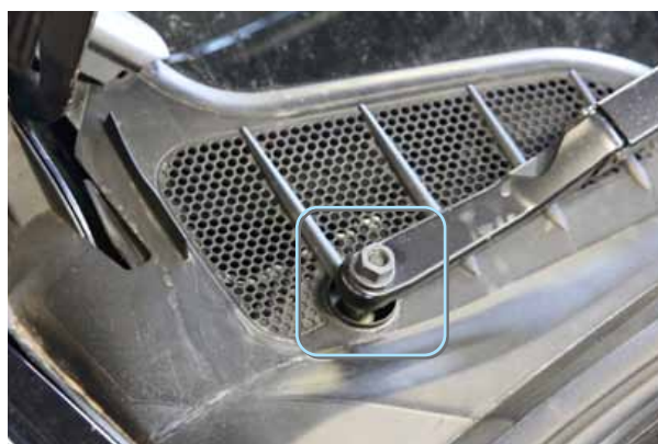
Фото 4.1. Гайка правого рычага
