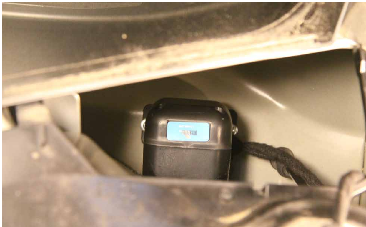
Фото 21. Сирена (крепление на 2 самореза)
