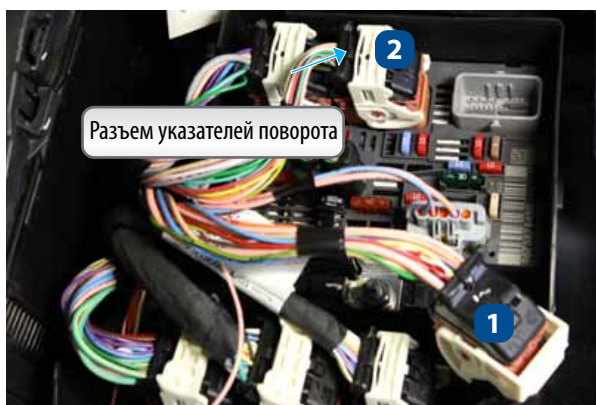
Фото 19.1. Разъём передних указателей поворота
