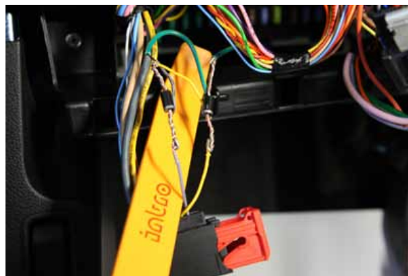
Фото 15.2. Подключение задних указателей поворота
