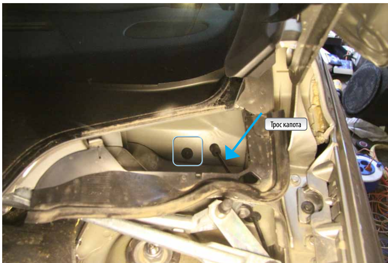
Фото 7. Штатное технологическое отверстие для прокладки жгута под капот
