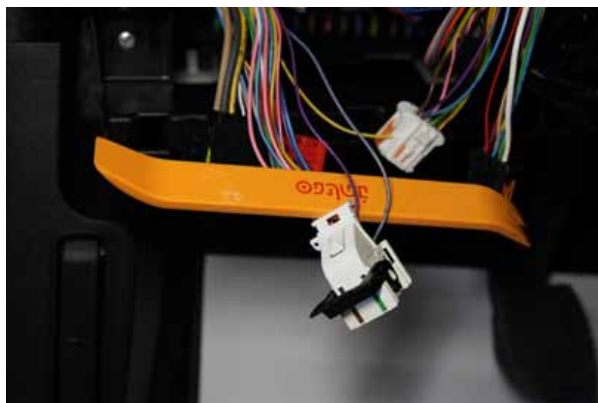
Фото 16.1. Подключение концевика багажника и концевиков дверей
