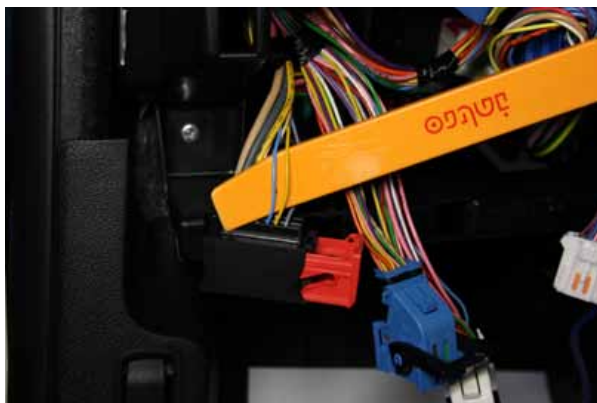
Фото 15.1. Подключение задних указателей поворота
