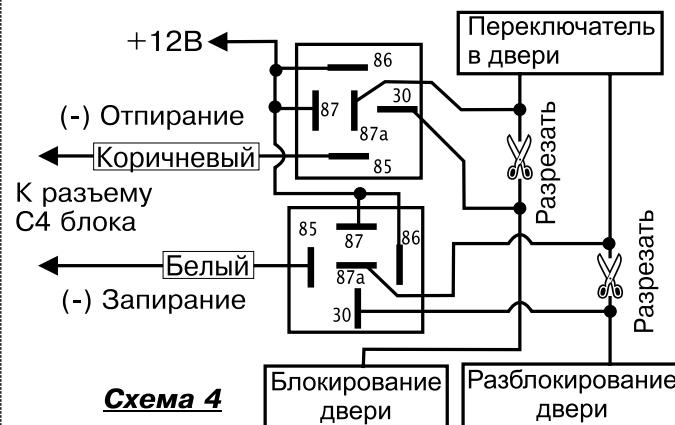
Схема управления ЦЗ (для управления требуется импульсы отрицательной полярности)
