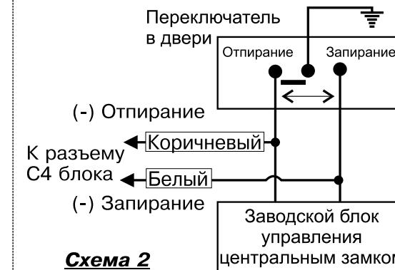
Схема управления ЦЗ (для управления требуется импульсы положительной полярности)
