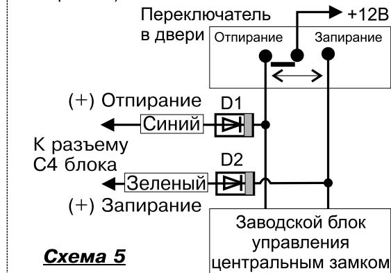
Схема управления ЦЗ с пневмокомпрессором – автомобили AUDI, MERCEDES (для управления требуется инверсия полярности в проводе управления и импульсы длительностью 4 сек. (Программируемая функция 4))
