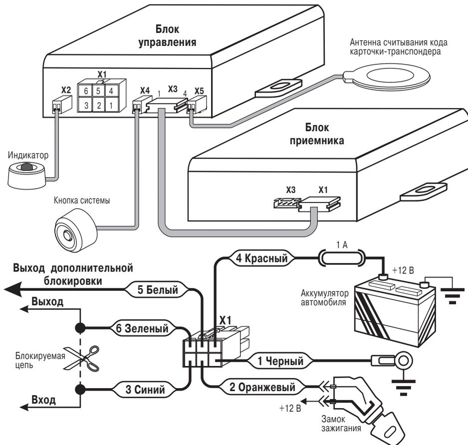
Контакты **встроенного реле блокировки** (зеленый и синий провода) замкнуты, если система находится в дежурном режиме и зажигание включено. При подключении к блокируемой цепи соблюдайте рекомендуемое направление тока через контакты встроенного реле блокировки.
