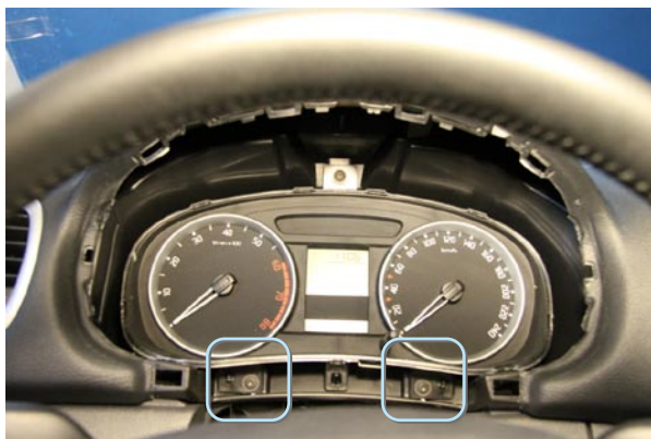
Фото 1. Крепление приборного щитка
