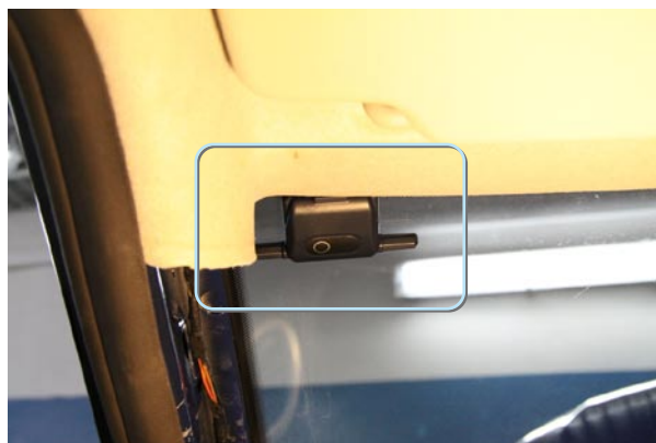
Фото 5.1. Антенна на лобовом стекле
