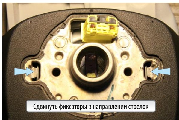
Фото 2.1. Снятие подушки безопасности
