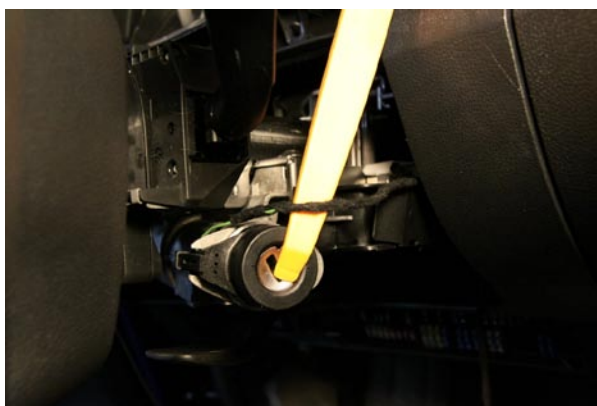
Фото 14. Провода штатной рамки иммобилайзера
