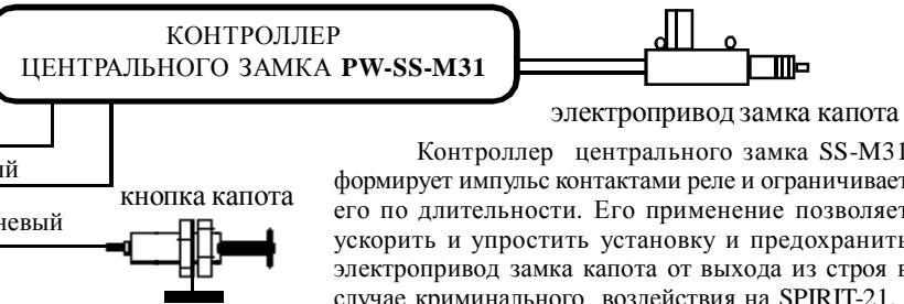
Контроллер центрального замка SS-M31 формирует импульс контактами реле и ограничивает его по длительности. Его применение позволяет ускорить и упростить установку и предохранить электропривод замка капота от выхода из строя в случае криминального воздействия на SPIRIT-21.
