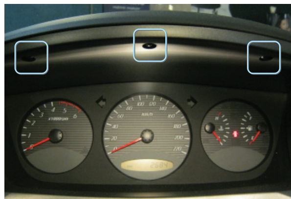
Фото 2.2. Крепление облицовки щитка
