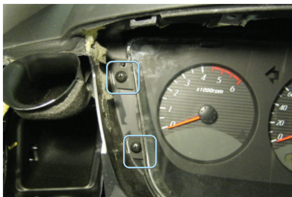
Фото 2.5. Крепление щитка приборов
