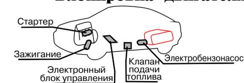
Блокировка должна препятствовать несанкционированному запуску двигателя и его работе в режиме ОХРАНА.
