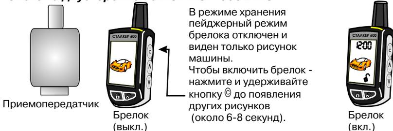
В режиме хранения пейджерный режим брелока отключен и виден только рисунок машины. Чтобы включить брелок - нажмите и удерживайте кнопку до появления других рисунков (около 6-8 секунд).
