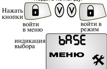
Комплекс подтвердит вход в режим программирования длинными красными вспышками светодиода и фразой речевого интерфейса.
