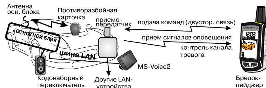
**Сервисные каналы** комплекса позволяют реализовать массу различных функций. Типичное использование каналов - **управление отпиранием и запираемостью электрозамков дверей, электрозамка багажника, блокировка, автозапуск и дистанционный запуск двигателя.**
