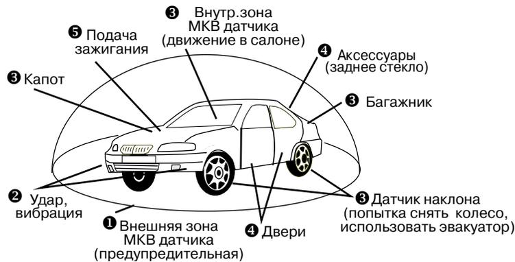
Если при постановке на охрану зона была не готова (была неисправна), то она исключается из числа охраняемых зон и подается предупреждение - 3 сигнала.
