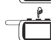
При включенном зажигании нажатие кнопки 2 брелка будет приводить к отпиранию замков дверей. На дисплее брелка будут отображаться иконки , .
