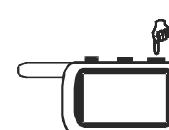
Включение режима “поиск” осуществляется двойным нажатием кнопки 3 брелка в течение 1 секунды. Последуют 6 сигналов сирены и 6 вспышек габаритов, прозвучит мелодичный сигнал брелка и на индикаторе брелка отобразится температура двигателя.
