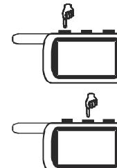
При включенном зажигании нажатие кнопки 1 брелка будет приводить к запиранию замков дверей. На дисплее брелка будут отображаться иконки , .
