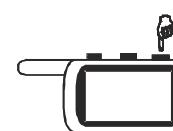
Нажмите и удерживайте кнопку 3 брелка в нажатом состоянии до появления сначала длительного, затем короткого звуковых сигналов брелка. После отпускания кнопки на индикаторе брелка начнет вспыхивать одна из иконок нижнего ряда. Короткими нажатиями кнопки 3 брелка установите курсор на иконку **MUTE ARM**.
