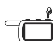
Включение / выключение канала №3 (желто-белый провод) осуществляется последовательным нажатием кнопки 3 брелка. Первое нажатие должно быть длительным, второе нажатие - коротким. Последуют 3 вспышки габаритов и 3 звуковых сигнала брелка.
