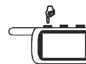
Нажмите кнопку 1 брелка. Система отреагирует 1 вспышкой габаритов. Прозвучат сначала 2 коротких, затем 2 длительных звуковых сигнала брелка, затем приглушенный звуковой сигнал брелка. На дисплее брелка высветится постоянно иконка **MUTE ARM**, показывая активацию автоматического включения режима охраны. При выключении режима бесшумной охраны иконка **MUTE ARM** погаснет.
