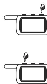
Нажмите и удерживайте кнопку 3 брелка в нажатом состоянии до появления сначала длительного, затем короткого звуковых сигналов брелка. После отпускания кнопки на индикаторе брелка начнет вспыхивать одна из иконок нижнего ряда. Короткими нажатиями кнопки 3 брелка установите курсор на иконку **AUTO ARM**.
