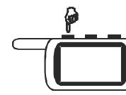
Нажмите кнопку 1 брелка. Система отреагирует 1 вспышкой габаритов. Прозвучат сначала 2 коротких, затем 2 длительных звуковых сигнала брелка. После приглушенного звукового сигнала брелка на его дисплее высветится постоянно иконка **2-STEP DISARM**, показывая активизацию функции 2-шагового выключения блокировки двигателя при выключении режима охраны.
