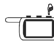
Нажмите и удерживайте кнопку 3 брелка в нажатом состоянии до появления сначала длительного, затем короткого звуковых сигналов брелка. После отпускания кнопки на индикаторе брелка начнет вспыхивать одна из иконок нижнего ряда. Короткими нажатиями кнопки 3 брелка установите курсор на иконку **2-STEP DISARM**.
