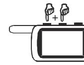
Для включения режима “паники” при выключенном зажигании одновременно длительно нажмите и удерживайте кнопки 1 и 2 брелка. Последуют 3 продолжительных сигнала сирены и 3 вспышки габаритов. Прозвучит звуковой сигнал брелка.
