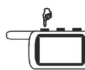
Нажмите кнопку 1 брелка. Система отреагирует 1 вспышкой габаритов. Прозвучат сначала 2 коротких, затем 2 длительных звуковых сигнала брелка, затем приглушенный звуковой сигнал брелка. На дисплее брелка постоянно высветится иконка **TURBO ON**, показывая активизацию автоматического включения режима охраны.
