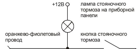
На автомобилях с автоматической КПП подключите этот провод к кнопке педали тормоза, замыкающейся на +12V при нажатии педали тормоза.
