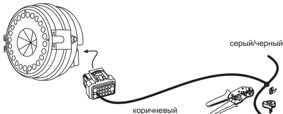
**BUS****Подключение к шине CAN BUS**
